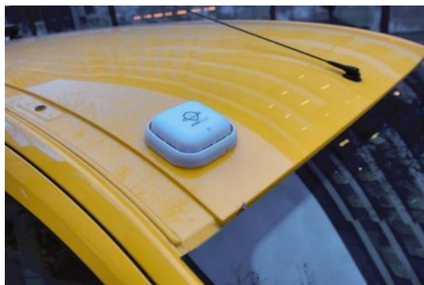
Figure 3 : Illustration d'un système-capteur AtmoTrack installé sur un véhicule de La Poste – source : La Poste
