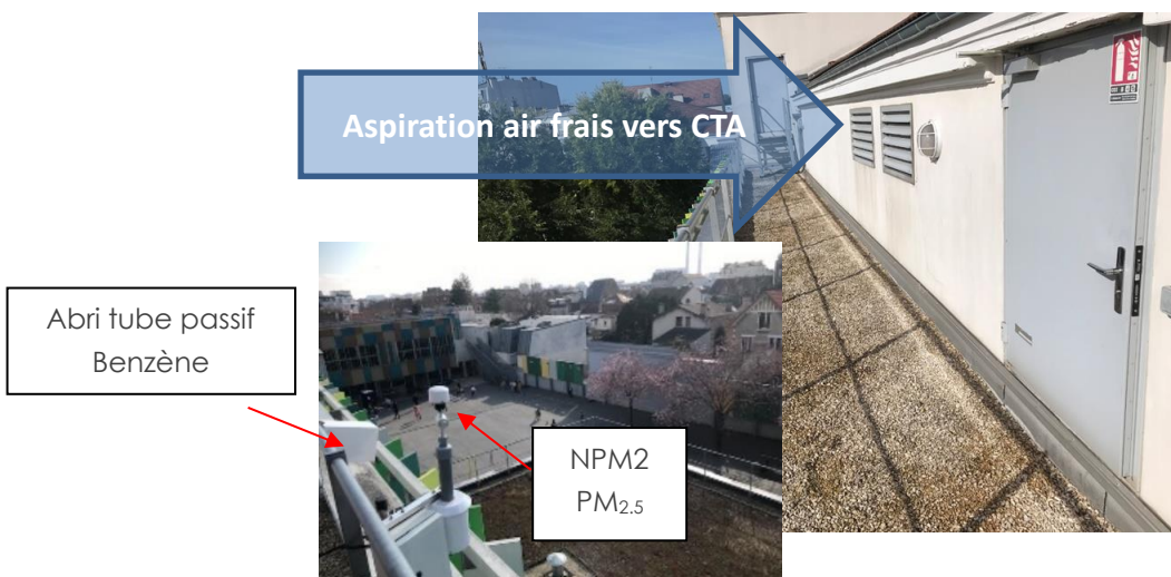
Figure 30 : Implantation du micro-capteur NPM2 mesurant les PM_{2.5} et du préleveur passif de benzène - en air extérieur
